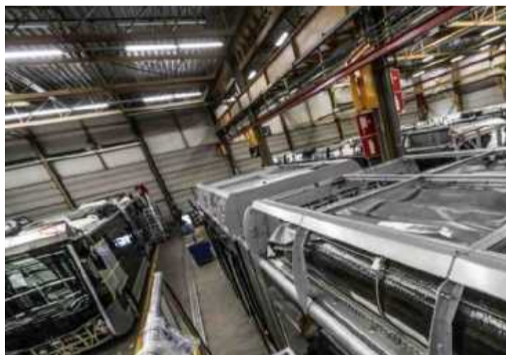
Les réservoirs d'hydrogène sur le toit du bus, une technologie gardée secrète
